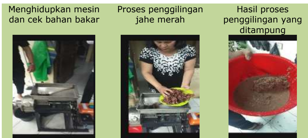
Gambar 3. Produksi Serbuk Jahe Merah dengan menggunakan Mesin Penggiling
